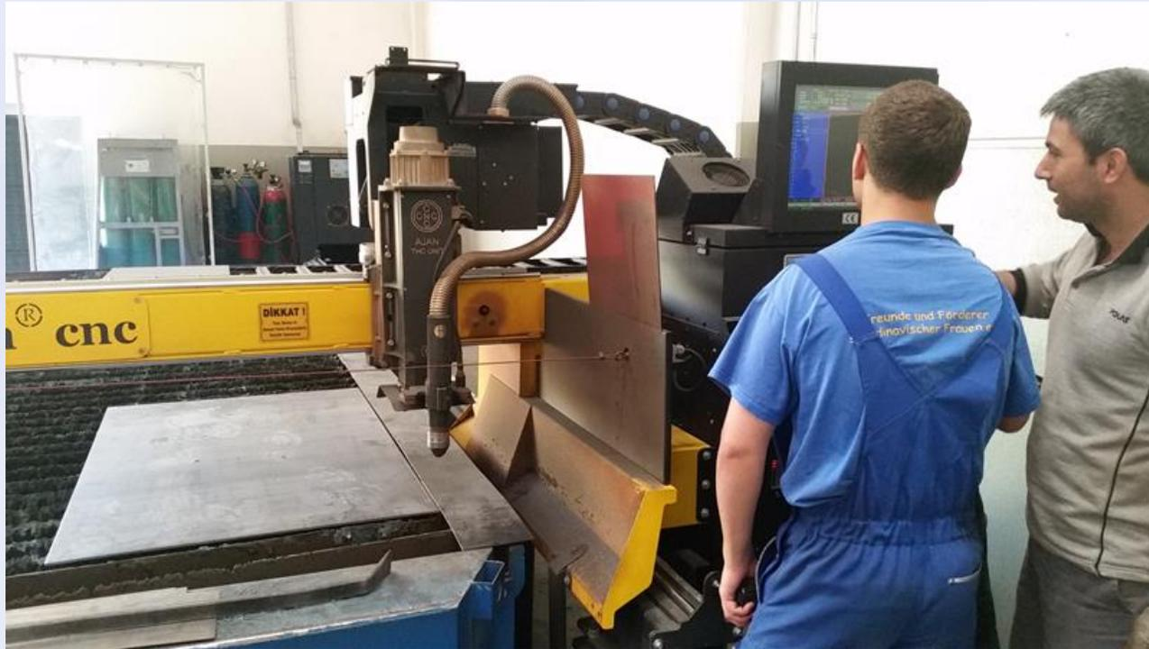
Links: Erklärung einer Plasmaschneidmaschine
