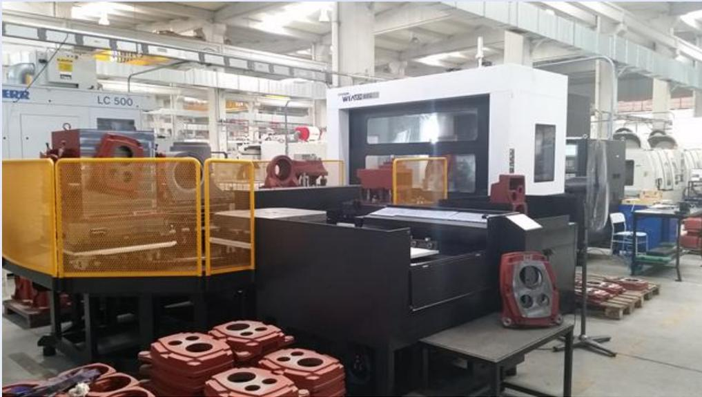
CNC-Fräsmaschine mit Werkstückmagazin
